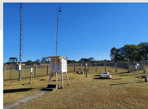
A Estação Meteorológica do INMET em Curitiba-PR, e em destaque o Abrigo Meteorológico.
